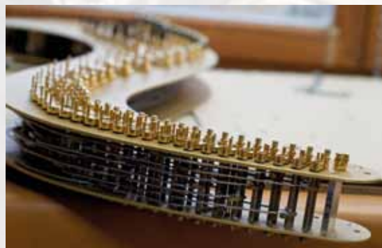
Mécanisme à double mouvement et à fourchettes sur la console d'une harpe Camac.
