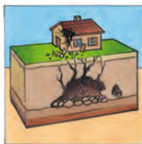
AFFAISSEMENT EFFONDREMENT (DÉPLACEMENT LENT À RAPIDE)
