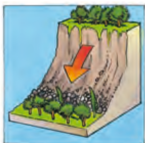
ÉBOULEMENT CHUTE DE BLOCS (DÉPLACEMENT RAPIDE)
