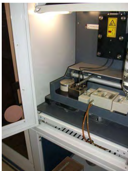
Test d'éco toxicité en continu sur l'eau brute de la Vésubie, par bactéries chimioluminescentes.
