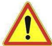
**K8** (signalisation de **position** d'une déviation ou de rétrécissement temporaire de chaussée) :
