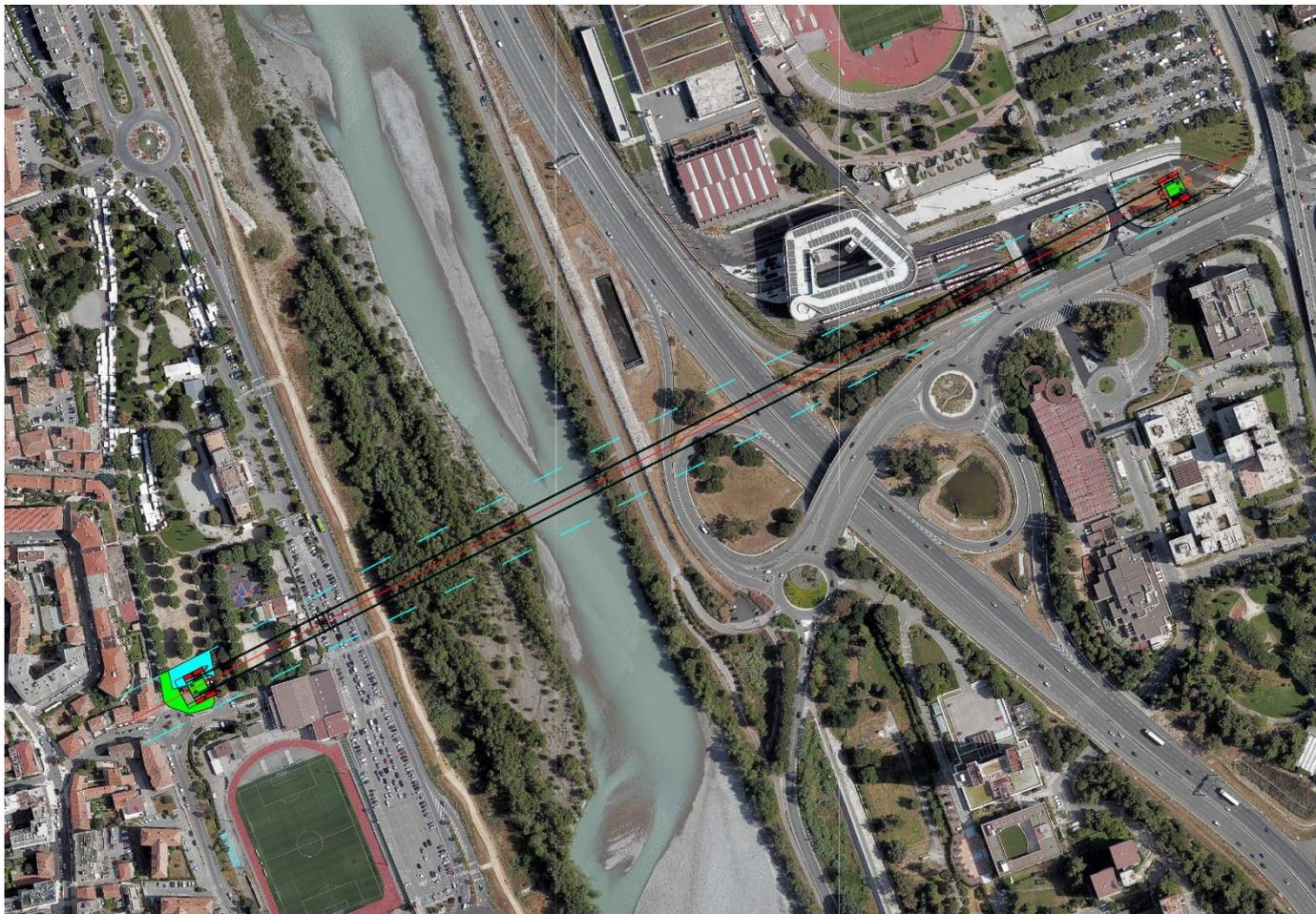
*Figure 7 : Tracé du projet (transport par câble en rouge, périmètre de prévention de la propagation du risque incendie en bleu)*
